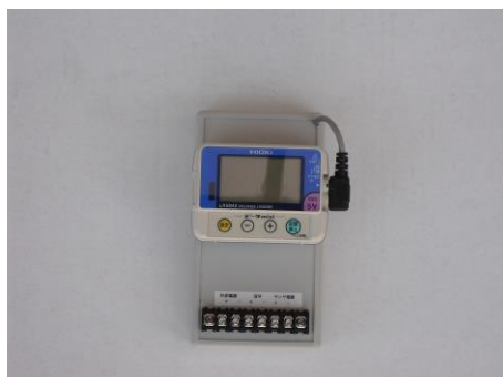
記録部・電源BOX
