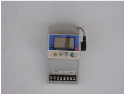
記録部・電源BOX
